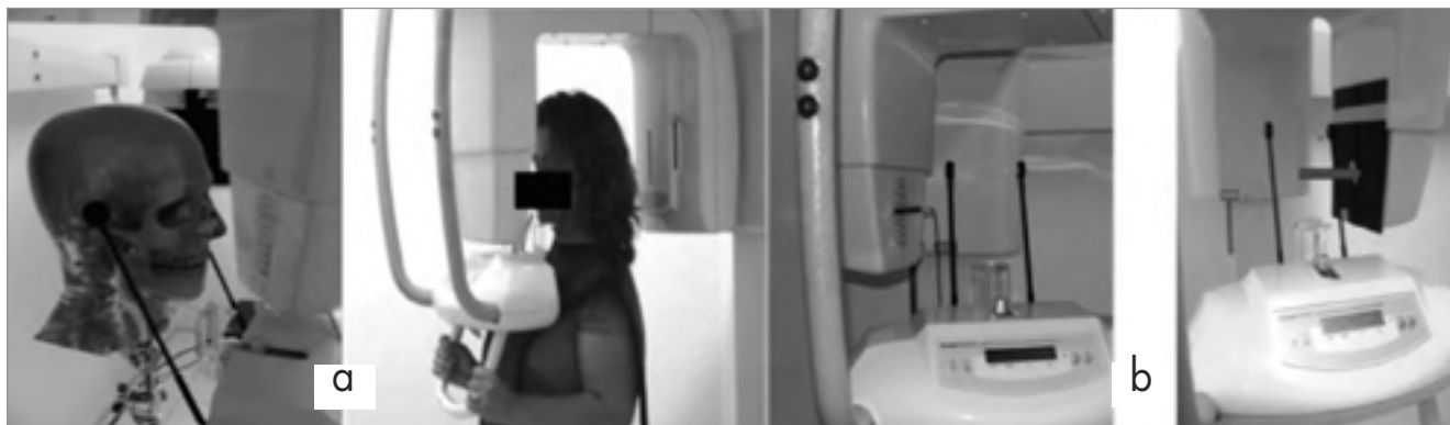
Figura 1. a) Ejemplo de adquisición panorámica con: a) maniquí y paciente ubicados en el campo de radiación, b) con la cámara de ionización y película filmica ubicadas en el campo de radiación.
