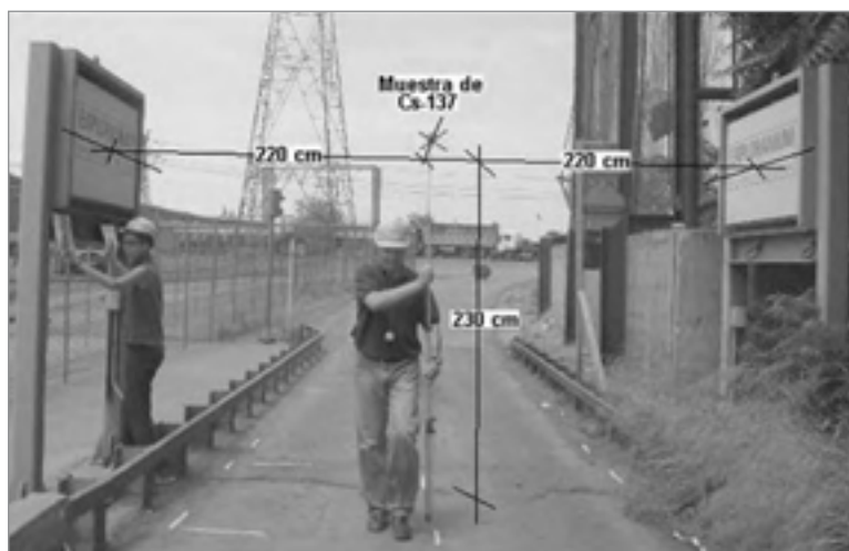
Figura 3. Medida de la eficiencia dinámica del paso de la muestra por la trayectoria central para el proceso de calibración (ensayo dinámico).
