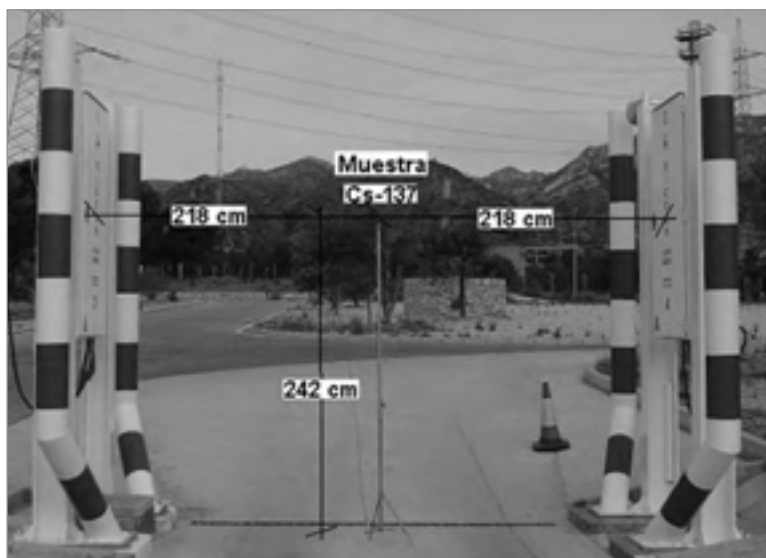
Figura 2. Medida de la eficiencia estática en el centro de la zona sensible de detección para el proceso de calibración (ensayo estático).
