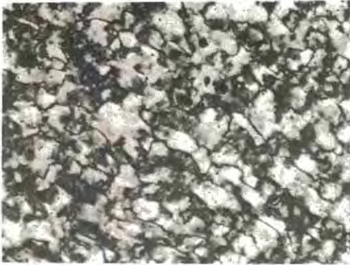
Foto 3. - Transformaciones diagenéticas de cristales de cuarzo destruyendo la estructura celular. NC x 40.
