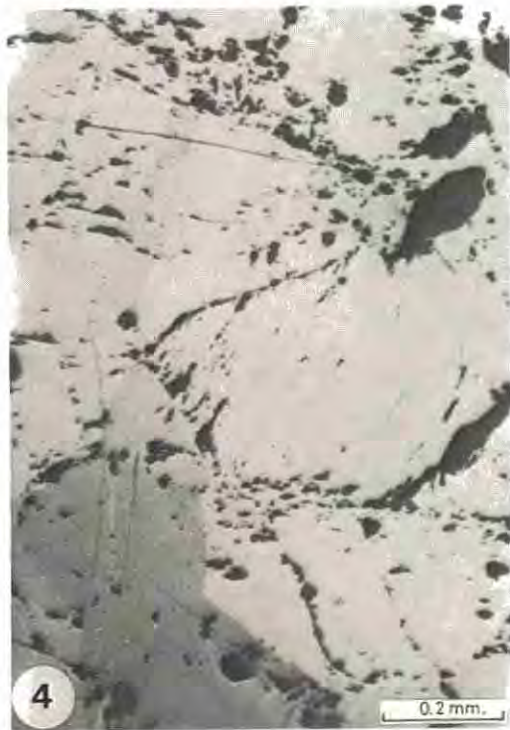
Foto 4.— Antimonita en cristales masivos, con abundantes oquedades y depresiones triangulares ("pits"). Luz reflejada, polarizadores a 30°.
