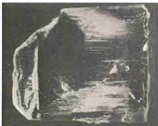
Fig. 7. - Distribución de inclusiones en forma de reloj de arena en un cristal de KDP crecido en condiciones irregulares.
