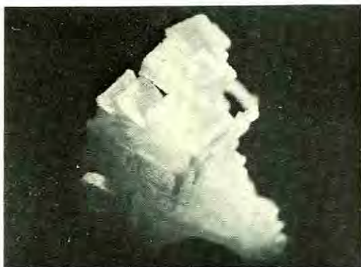
Fig. 4.— Tolva tridimensional de NaCl obtenida a partir de soluciones hirvientes.
