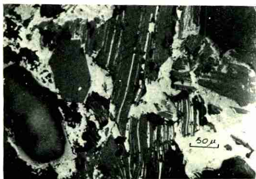
Fig. 4.— Minerales micáceos (gris oscuro) con deposición de hematites (blanco) en los planos de exfoliación. Luz reflejada. N.P.
