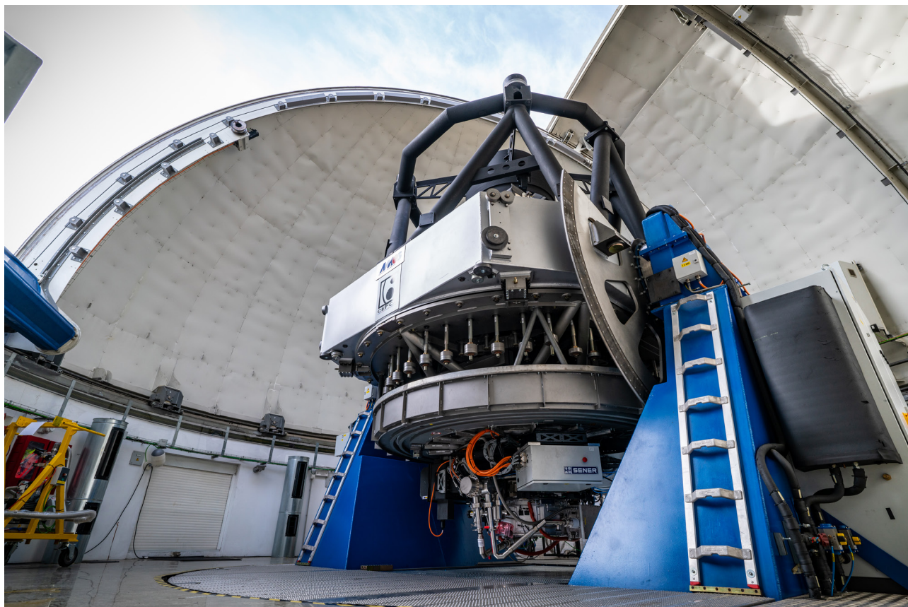
Figura 1. El Javalambre Survey Telescope (JST250) del Observatorio Astrofísico de Javalambre y su instrumento científico principal JPCam, integrado en el foco Cassegrain.
