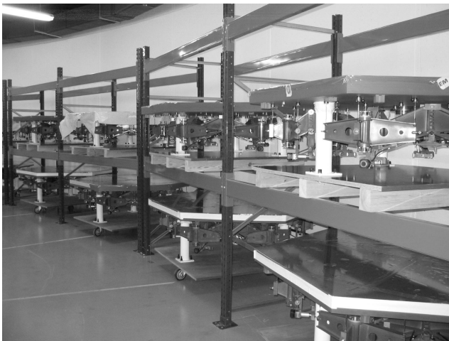
Figura 5 — Dos lotes de segmentos apilados en estanterías en la sala de espejos del edificio del GTC. En las estanterías de la foto aún se puede montar otra fila de segmentos. El cuarto lote iría en el suelo.
