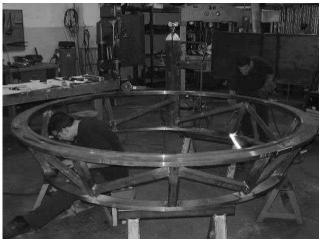
Figura 6 — El flanco de anclaje de OSIRIS al rotador Nasmyth del GTC en la factoría de Valencia donde se está fabricando.
