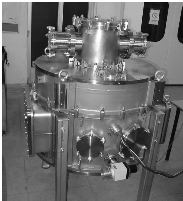
Figura 8 — El criostato de pruebas de EMIR ya integrado en uno de los laboratorios del IAC. Este criostato, de más de un metro de diámetro, será utilizado para probar en frío lentes y otros elementos ópticos de EMIR, muy especialmente la ventana de entrada, que por su tamaño es un elemento complicado de EMIR
