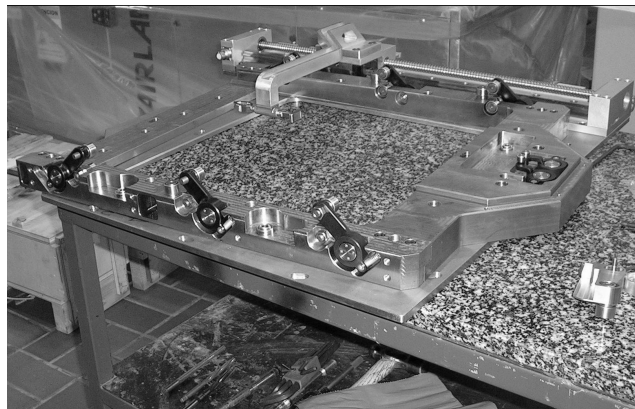
Figura 7 — El selector de máscaras de OSIRIS en el taller del IAC. Este subsistema, de gran complejidad, se está fabricando enteramente en el taller del IAC, y consta de más de 1800 piezas. El cambiador de máscaras estará operativo en los primeros meses de 2005.
