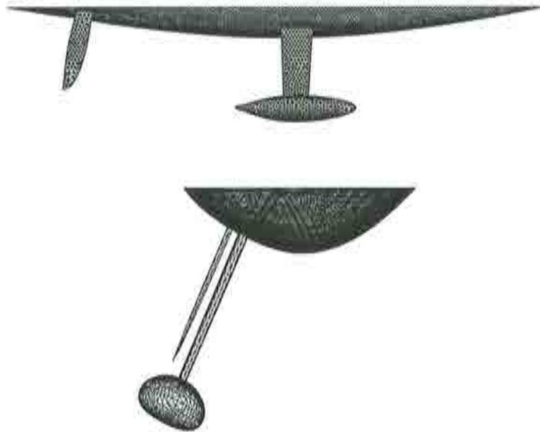
Figura 7.16. Velero Rioja de España. Geometría del casco y apéndices. Vista lateral y vista frontal.
