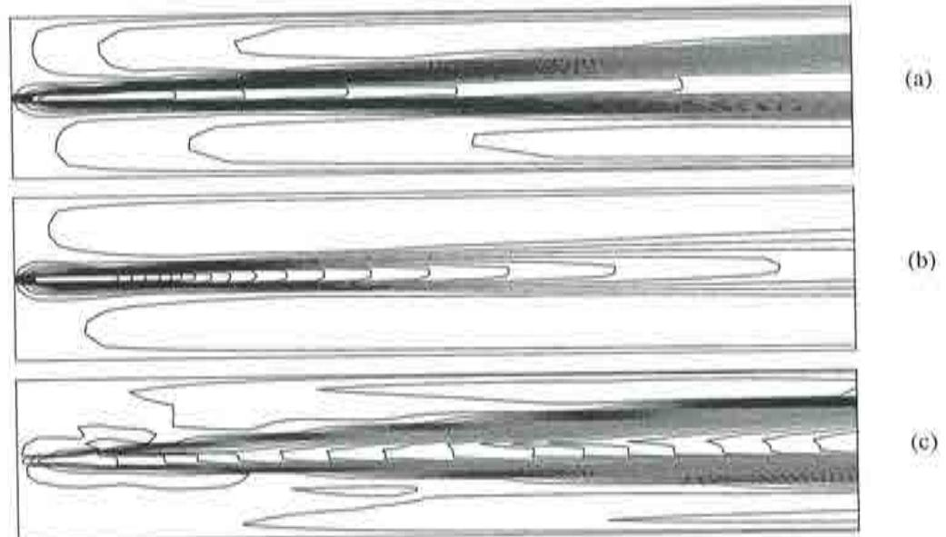
**Figura 5.4.** Turbulencia en una capa de mezcla. Modelo  $k-\varepsilon$ . Método SUPG+ASC. (a): Contornos de  $k$ . Picos  $(0.0499, 0.00199)$ . (b): Contornos de  $\varepsilon$ . Picos  $(0.125, 0.00104)$ . (c): Contornos de viscosidad cinemática total. Picos  $(0.00598, 0.000396)$ .
