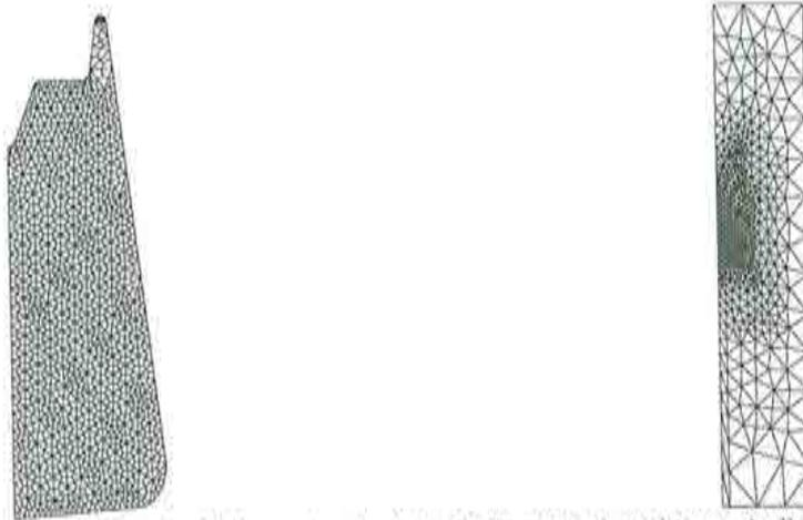
**Figura 6.2.** Llenado bidimensional. (a): Malla para el problema de llenado. 532 elementos  $P2^+/P1$  y 1638 nodos. (Cada elemento se encuentra dividido en 4 cuadriláteros para visualizar todos los nodos). (b): Malla para el problema de calor. 948 elementos  $P1$  y 507 nodos.
