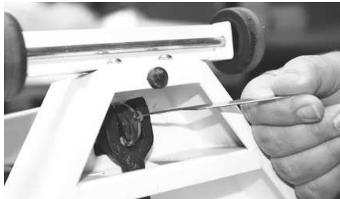
Figura 2-4. Conectando la vara de medición a la base de la báscula
