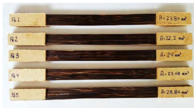
Figura 3. Probetas ensayo de tracción
