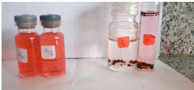
Figura 1. Gráfica de % de remoción vs pH (izquierda), soluciones de Rojo 40 50 mg/L a pHs 2 (A0) y 3 (A1) antes y después de añadirles las PQM.
