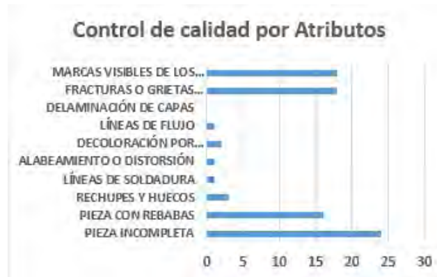
Figura 3. Control de calidad de las probetas inyectadas.
