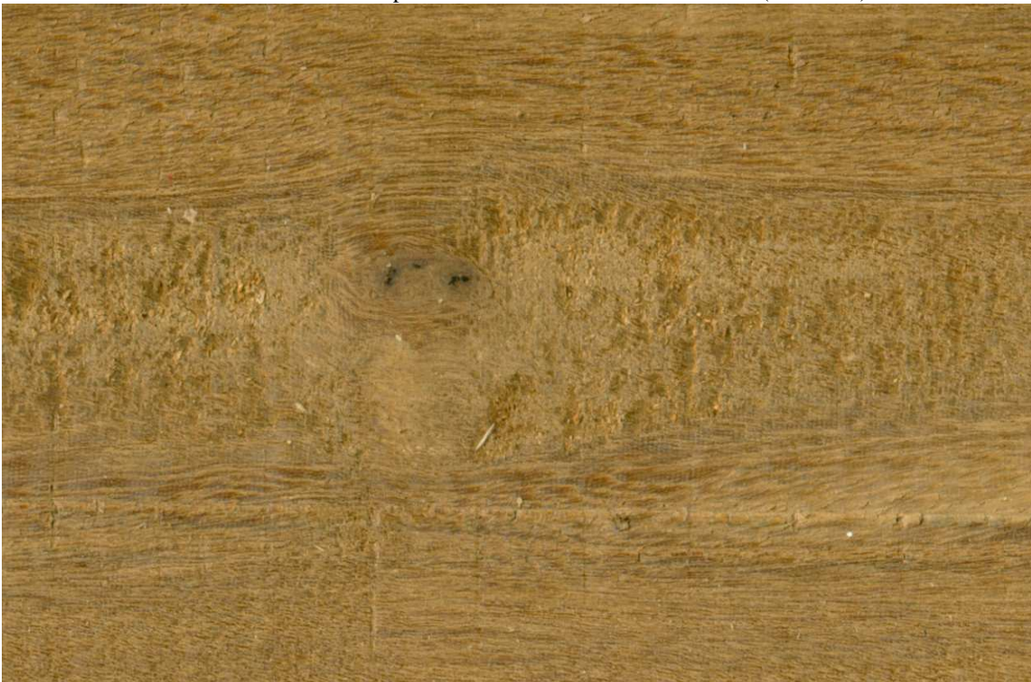
Foto 22: Repelo en madera con la fibra entrelazada (escala 1:1)
