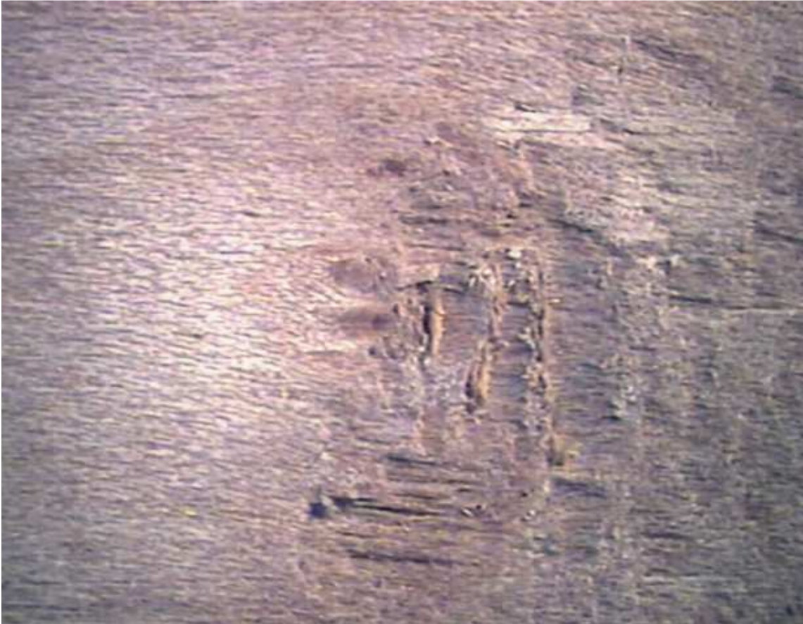
Foto 22: Repelo en madera con la fibra entrelazada (escala 1:1)
