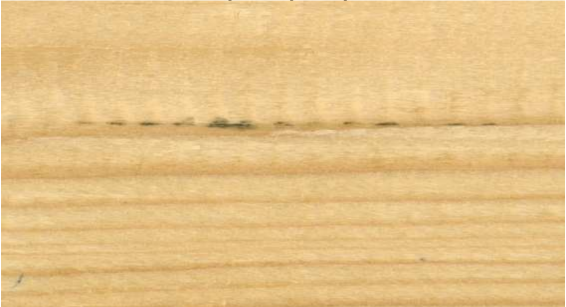
Foto 14: Marcas de cuchillas provocadas por una cepilladora (escala 1,5:1)
