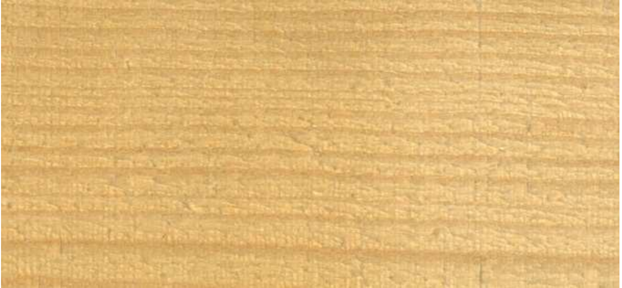
Foto n°12: Marcas de dientes producidos en una sierra de banda de mesa (escala 1:1)
