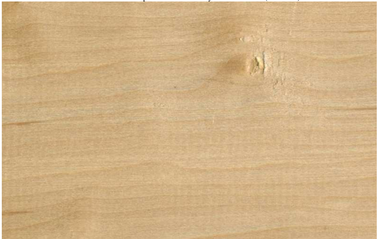
Foto 20: Repelo en madera de haya debido al nudo (escala 1:1)
