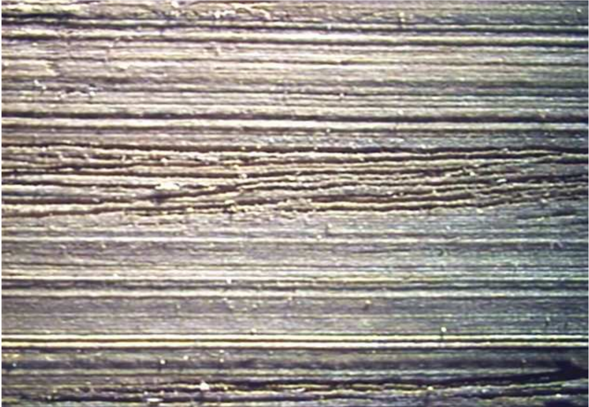
Foto 16: Aspecto aumentado de la superficie de fresno trabajada con cuchilla (escala 6,4:1)
