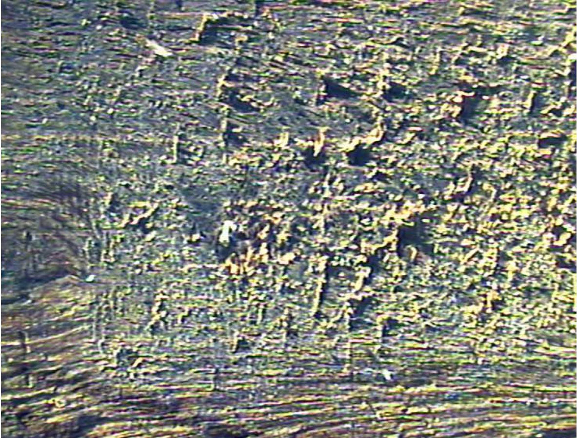
Foto 23: Detalle de repelo en madera con la fibra entrelazada (escala 1:6,4)
