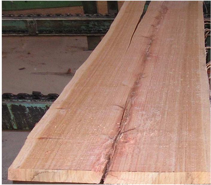
Foto 7: Fenda debida a tensiones de crecimiento
