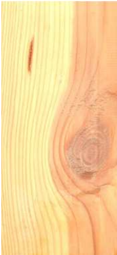
Foto 3: Pieza con albura y duramen y bolsa de resina
