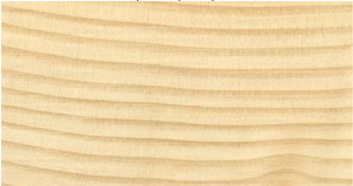
Foto 17: Superficie trabajada con lija (escala 1:1)
