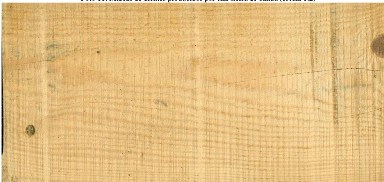
Foto 11: Marcas de dientes producidos por una sierra de banda (escala 1:2)
