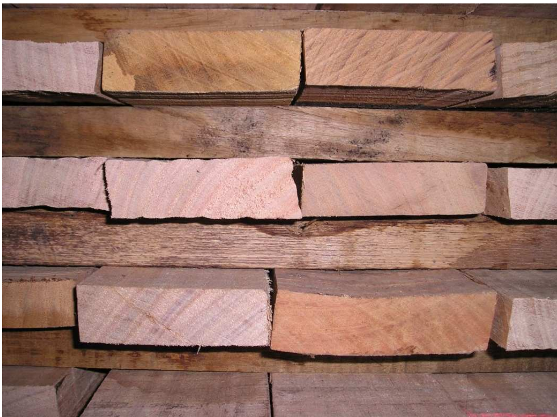
Foto 27: Formación de fendas internas y arrombamiento de la sección, típicos del colapso
