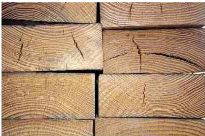
Foto 26: Fendas internas producidas por cementado
