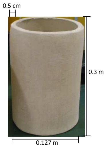
Figura 23.- Membrana cilíndrica de ZNM + arcilla sinterizada a 600 °C.
