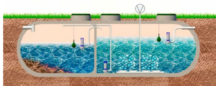
Figura 15: Ejemplo de depuradora SBR con decantador primario, sistema de aireación mediante difusores de burbuja fina y soplante exterior
