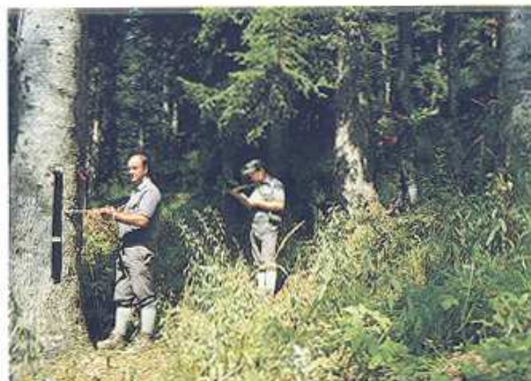
Personale forestale che esegue rilievi in foresta per la redazione del piano economico dei boschi del Comune di Ligosullo (1979). Vengono rilevati (per campioni) i diametri delle piante, le altezze e gli incrementi con l'uso del cavalletto, dell'ipsometro e del succhiello.
