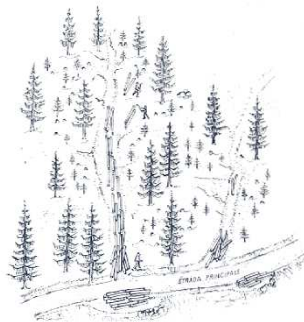
Schema di esbosco per avvallamento lungo mortors (impluvi).
