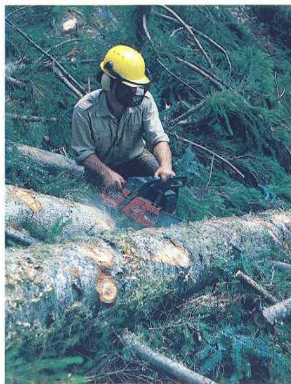
Boscaiolo durante l'operazione di sramatura e sezionatura; il casco con cuffie e visiera è essenziale per evitare infortuni. (Comune di Prato Carnico: Bosco Ongara - A.B.F. di Pesariis).
