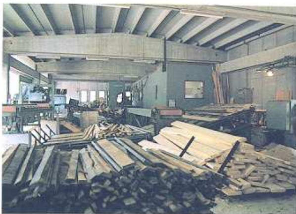
Interno di una segheria in Carnia: si vedono la sega di testa, il refendino, la rifilatrice e la linea automatizzata per lo spostamento e smistamento degli assortimenti segati. (Comune di Ovaro).
