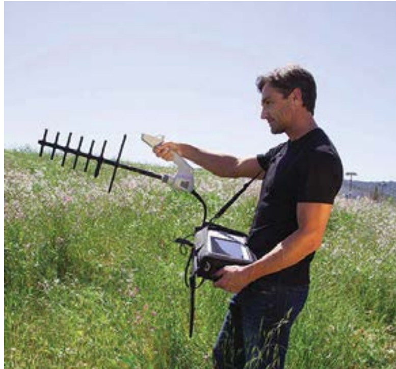
Figura 5a. Antena direccional conectada al Interference Hunter para localizar una señal.
