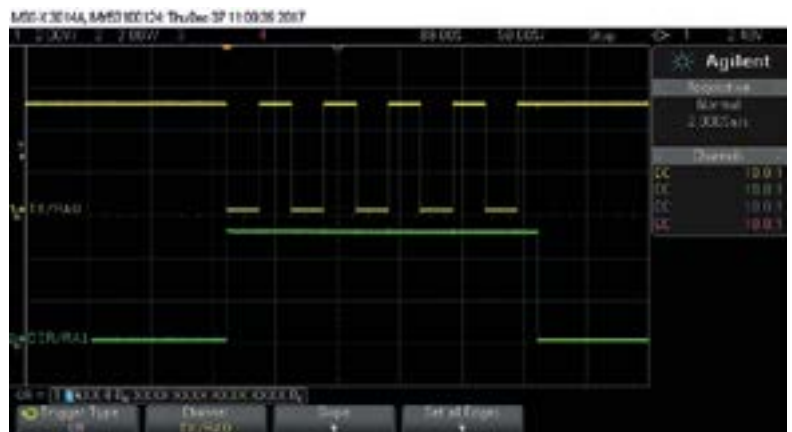
Figura 2. El bit de inicio activa un temporizador interno para mantener el control de dirección en la transmisión hasta la mitad del bit de parada.
