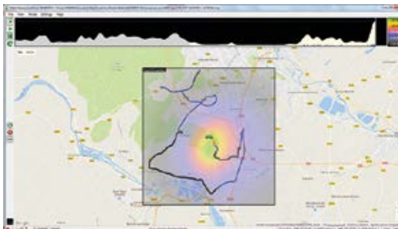
Figura 4b. Modo Spot Drive (conducción y localización) del software Mobile Interference Hunter que muestra el mapa térmico e indica dónde puede hallarse la fuente de señal.
