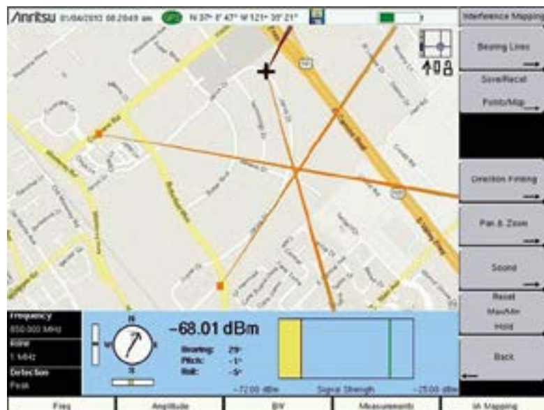
Figura 5b. Opción de generación de mapas de interferencias con el analizador de espectro MS2720T que muestra tres azimuts diferentes que se cruzan en la supuesta posición de la fuente de interferencias.
