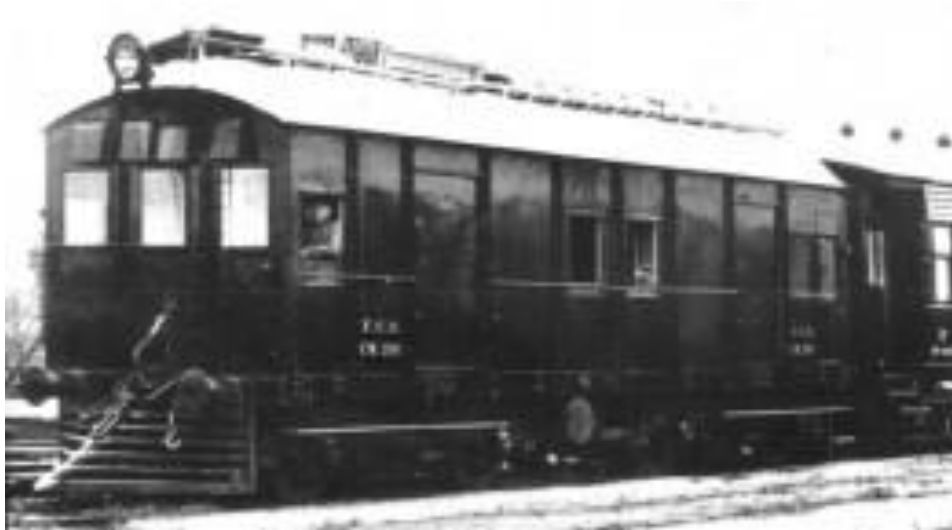
Imagen 74. Locomotora diesel-eléctrica experimental Ca. 1930. Fuente: Web
