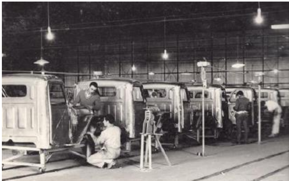
Imagen 102. Carros soporte de la cabina para desplazamiento en la línea de montaje de accionamiento manual Fuente Picabea (2011: 89)
