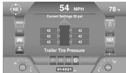
Sistema de monitoreo de presión de los neumáticos del remolque (TTPMS)
