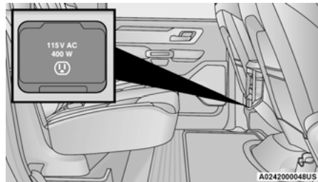
Toma de corriente del inversor de corriente de la consola central trasera
