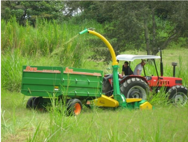
Cosechadora para pastos de piso tipo “choper”
