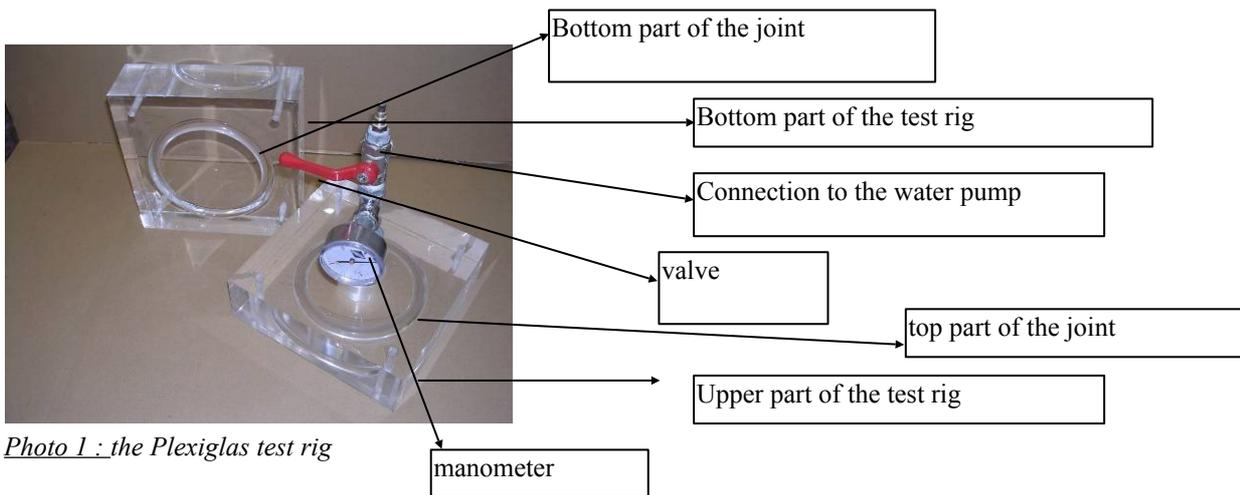
*Photo 1 : the Plexiglas test rig*
