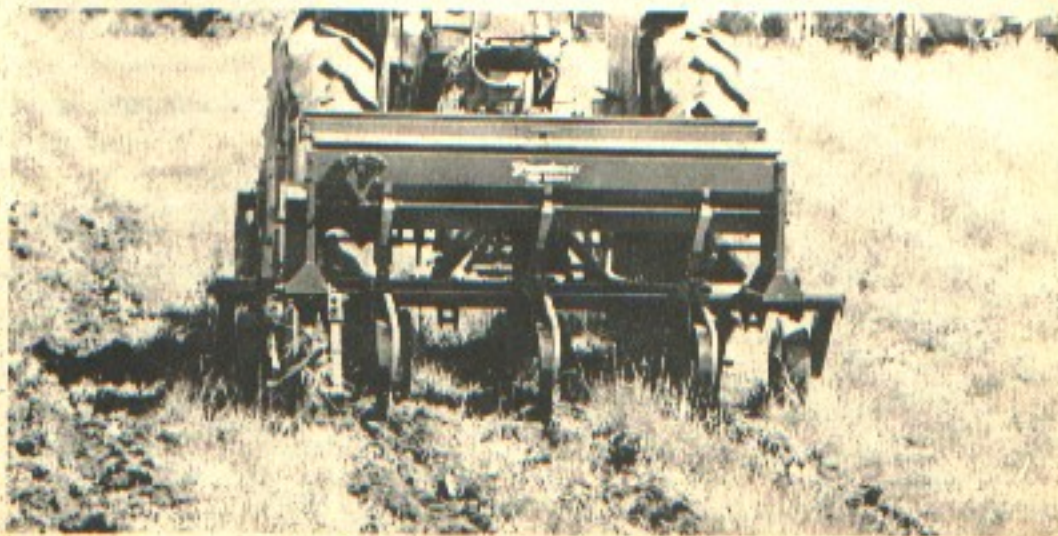
Vista de la sembradora a zapatas trabajando.
