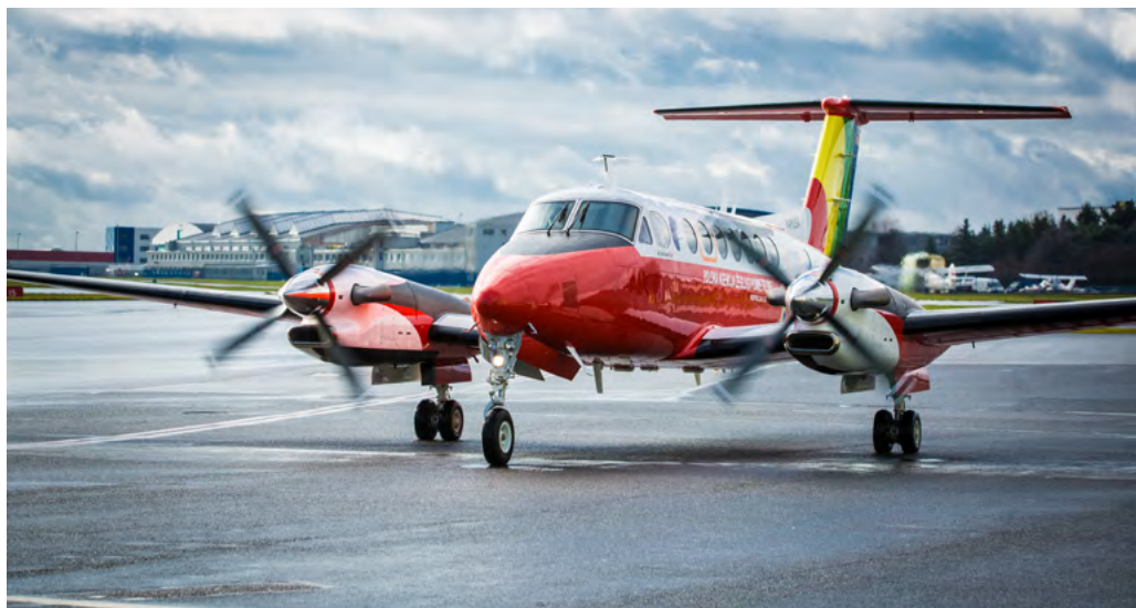
Fot. 5. Samolot kontrolno-pomiarowy Inspekcji Lotniczej PAŻP Beechcraft King Air 350i, zwany Papugą
