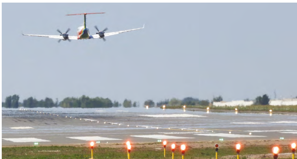
Fot. 7. Samolot pomiarowy w czasie kontroli z powietrza świateł nawigacyjnych Autor: B. Marciniak, Port Lotniczy Poznań-Ławica
