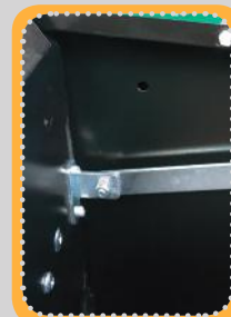
Sensor caída de producto que impide que la máquina realice venta falsas
