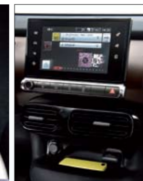
▲ La pantalla táctil de 7 pulgadas es de serie y fija, y con ella se maneja desde la climatización hasta internet, siempre que se haya comprado el dispositivo Citroën eTouch.
