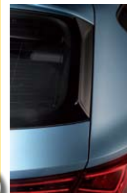
◀▲ El León Ecomotive va 15 milímetros más pegado al suelo –amortiguadores del Style, muelles del FR– y monta un alerón específico, que se prolonga por los laterales de la luneta.
