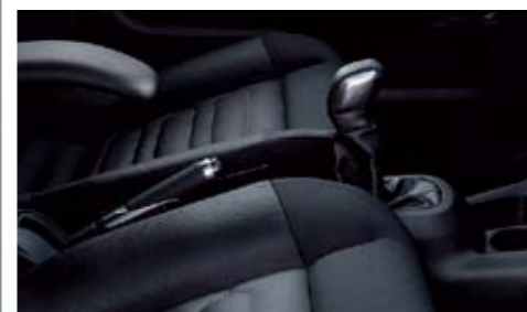
▲ Con cambio manual y dos asientos el freno de mano es tradicional. Y 'de diseño' con el cambio ETG6 y asiento corrido.
