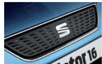
▲ Parrilla frontal superior cerrada para mejorar la aerodinámica.
