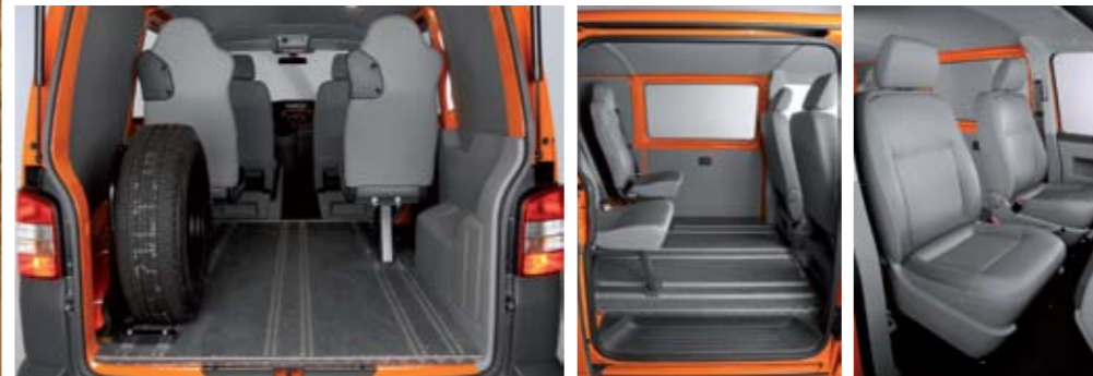
▲▲ La rueda de repuesto, igual al resto, va en el interior. Los asientos traseros individuales se adquieren de uno en uno para tener un interior con hasta siete ocupantes.
