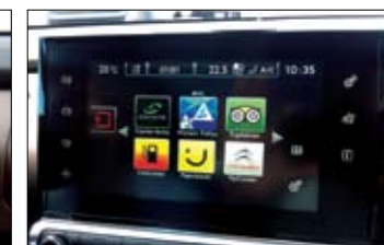
▲ La pantalla táctil de 7 pulgadas es de serie y fija, y con ella se maneja desde la climatización hasta internet, siempre que se haya comprado el dispositivo Citroën eTouch.
