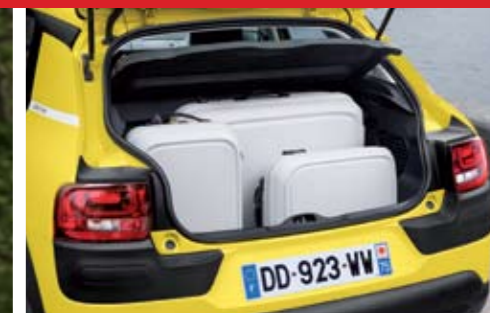
▶▶ El maletero, con un piso profundo gracias al sencillo esquema de suspensión, tiene 348 litros. La guantera del salpicadero es muy grande.
