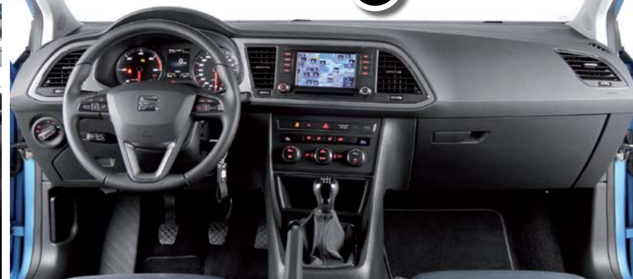
▲ Como el resto de la gama, el León Ecomotive lleva función Start/Stop, desconectable por botón. La recuperación de energía en frenada y otras soluciones reducen el gasto a 3,3 l/100 km, valor que comparte con las carrocerías SC y ST.
