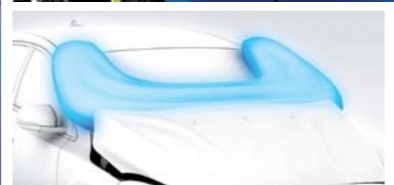
▲ Una de las últimas novedades mundiales de Volvo es el airbag para peatones del V40.
