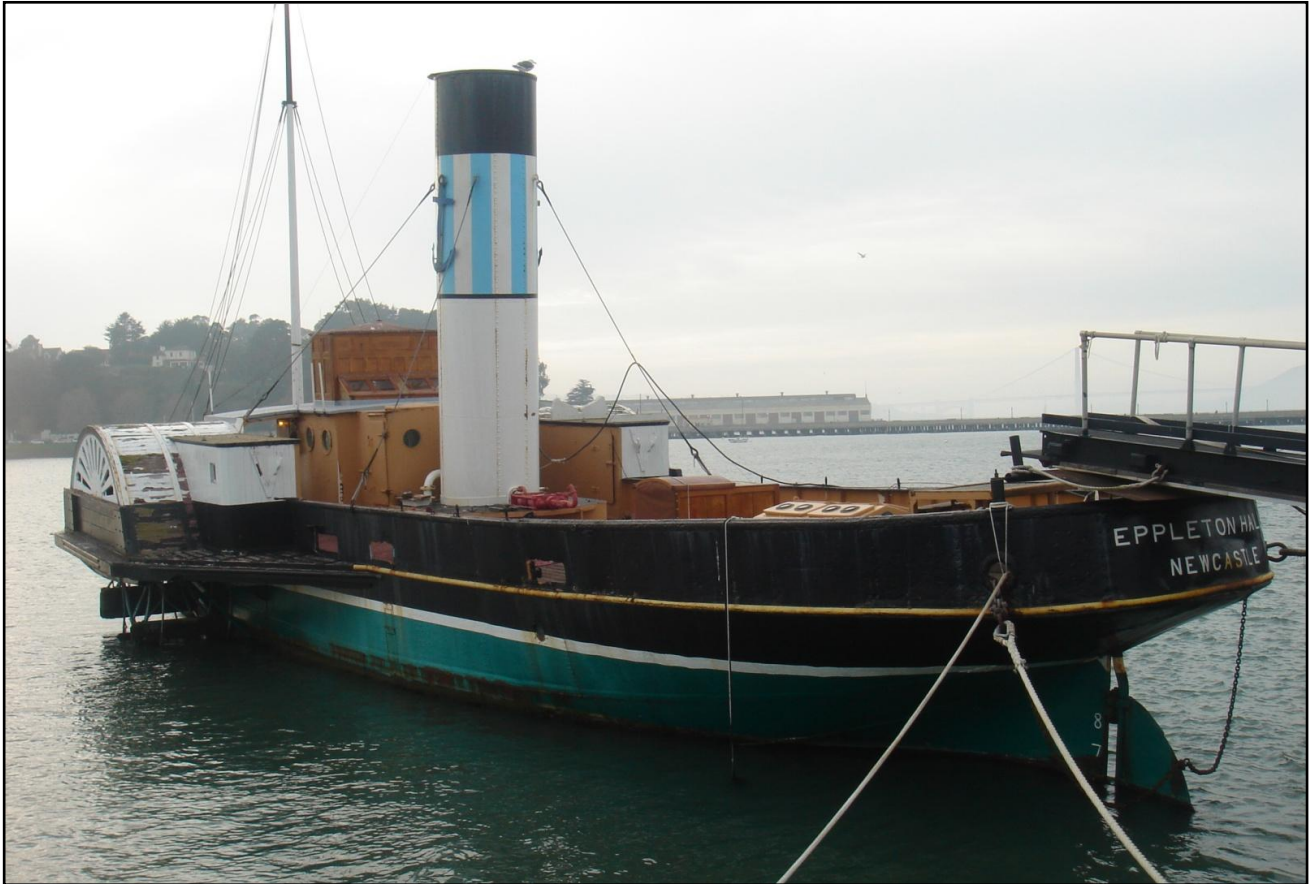
Eppleton Hall: remolcador a vapor impulsado por ruedas de palas y utilizado entre 1850 y 1860 para remolcar barcazas que transportaban carbón, anclado actualmente en San Francisco Maritime National Historical Park Foto Rafael Zambrino, San Francisco, USA.
