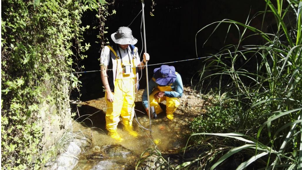
Figura 7. Toma de datos con correntómetro y sensor de velocidad superficial.
