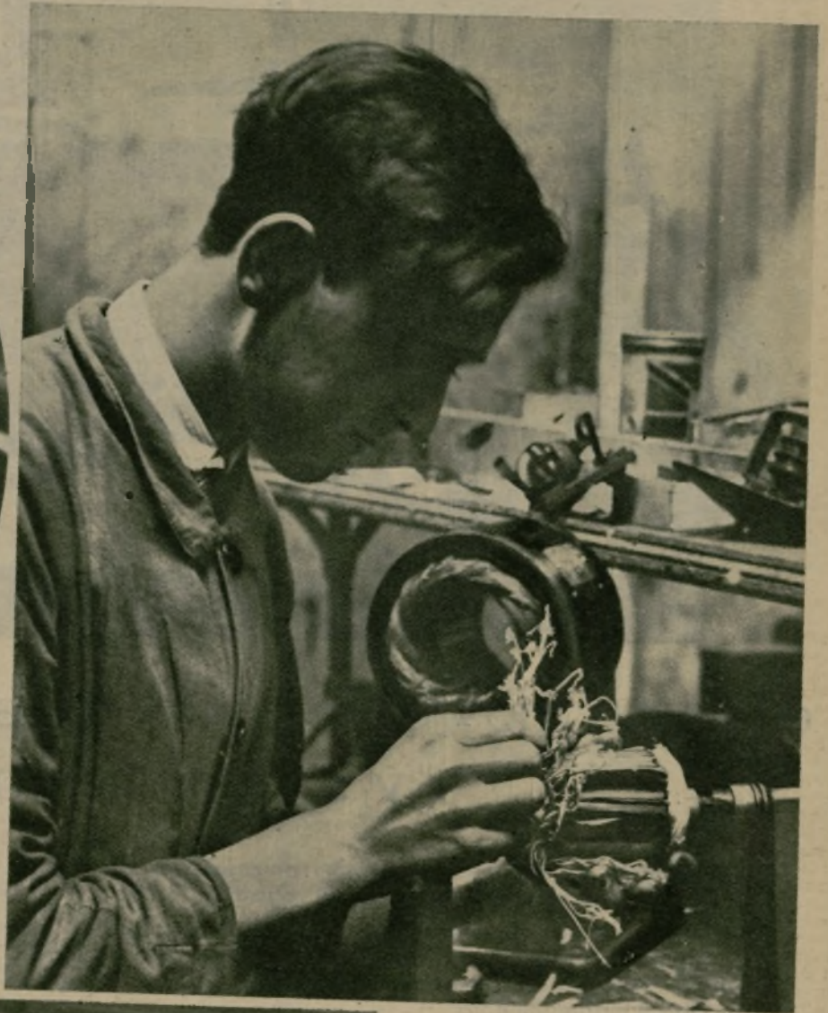
La penosa reparación que es preciso hacer a un inducido de dínamo, que por el mal funcionamiento a que se le sometió, debido al abandono, quemó todos sus aisladores
