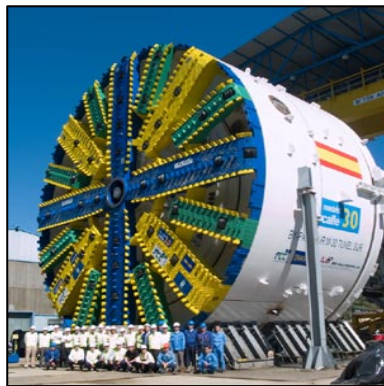
Tuneladora de doble escudo
