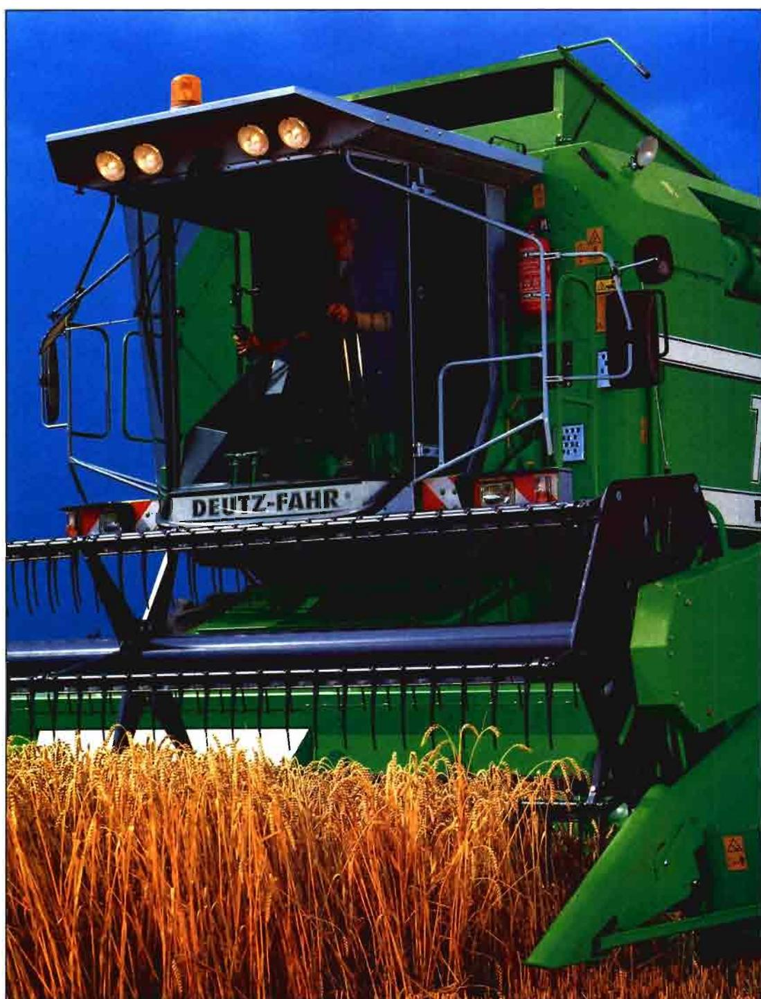
Las nuevas cosechadoras TopLiner incorporan una plataforma de corte de hasta 7,20 m, un nuevo sistema de trilla, una gran bandeja de grano y prolongación de la tolva con capacidad para 9.500 l.
