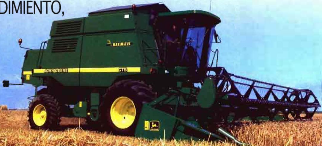
*CTS significa conjunto de trilla y separación por dedos. Un nuevo y eficaz sistema de separación: Dos cilindros de dedos en rotación inversa son la base del diseño de la CTS.*
