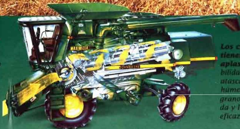
*Los cilindros de dedos mantienen la paja esponjosa, sin aplastarla. Ello reduce la posibilidad de apelmazamientos o de atascos, incluso en condiciones húmedas. La separación del grano se produce de forma rápida y limpia. Una recolección más eficaz. Día tras día.*
