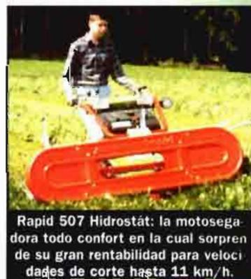
Rapid 507 Hidrostát: la motosegadora todo confort en la cual sorprende su gran rentabilidad para velocidades de corte hasta 11 km/h.
