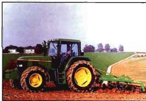
y 6,8 l de cilindrada. Con una fuerza máxima de 106 cv, inyección directa, potencia constante entre 1.900 y 2.300 rpm y una reserva de par del 34,5%, esta unidad motriz proporciona al tractor una alta capacidad de tiro, incluso al trabajar en terrenos de fuerte textura y gran pendiente.
