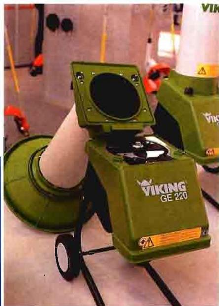
Vistas del sistema de corte donde se aprecia la disposición de las cuchillas sobre un eje vertical.
