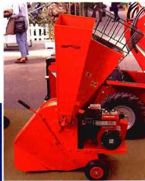
Aspecto típico de una biotrituradora donde se observa el motor térmico, el tubo de alimentación y se advierte el triturado oculto tras la carcasa en la parte inferior.
