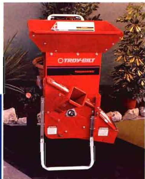
Biotrituradora con doble tubo de alimentación, uno para ramas, etc., y otro para residuos de mayor tamaño.
