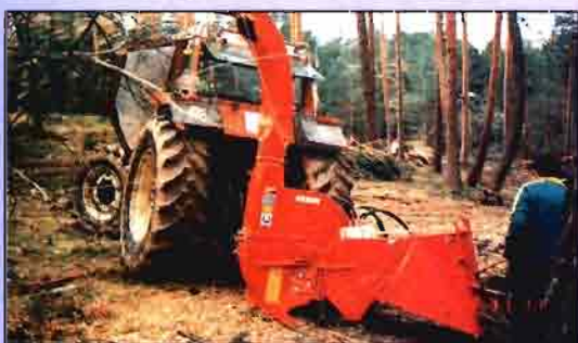
Astilladora accionada en la parte del corte por la toma de fuerza, pero la alimentación es con energía hidráulica.
