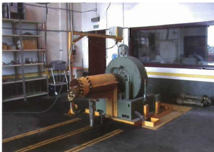
Freno dinamométrico para el ensayo del tractor en la TDF (EMA-España).
