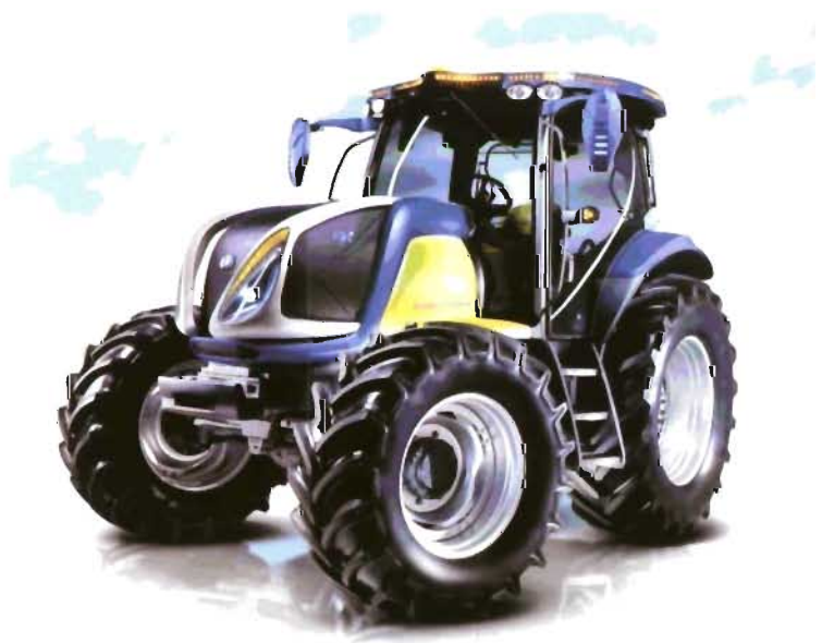
Tractor experimental con pila de combustible alimentada con hidrógeno (New Holland).
