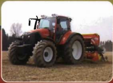
Cabezal 460 ancho de trabajo 6 m.
