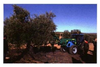
de contrapeso, especialmente necesario cuando el vibrador dispone de paraguas. Sin embargo, conviene disponer de un sistema hidráulico propio del tractor que facilite el movimiento de una pala frontal o de los brazos que soportan los vibradores.
