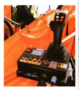
para almendra incluyen activación y desactivación individualizada de despellejadoras y sinfines, con regulación independiente de la velocidad. No sufren variación de velocidad cuando se actúa con el acelerador del vehículo y no se detienen durante la vibración.
