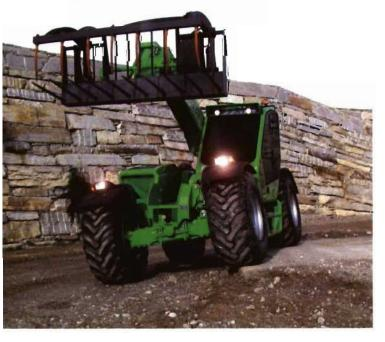
s una máquina concebida con el objetivo de exaltar el concepto de polivalencia en las operaciones de manipulación y elevación en las empresas agrícolas y en los trabajos en campo abierto, ofreciendo la misma velocidad y la misma capacidad que un tractor agrícola.
