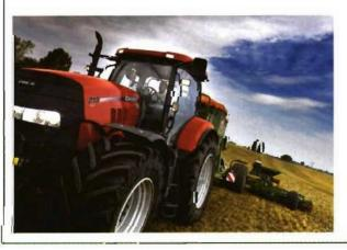
La tecnología Efficient Power EP de Case IH permite a los nuevos motores ofrecer un 23% más de potencia nominal logrando aumentar su productividad. Su sistema hidráulico le proporciona una capacidad extraordinaria y gran precisión de control con un caudal máximo de 170 L/min. Cuentan con una capacidad de elevación de hasta 10 460 kg.
