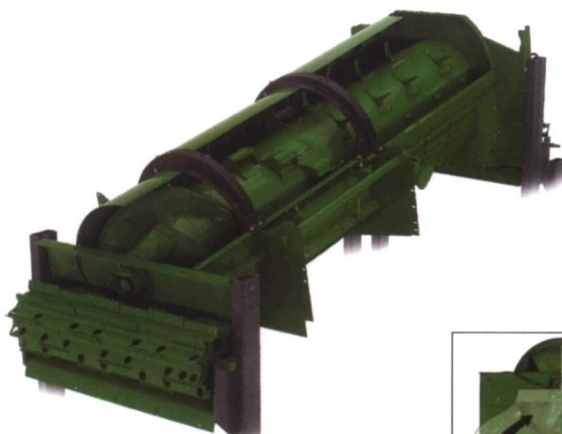
Cilindro trillador-separador y cubiertas en las cosechadoras S690 de John Deere.
