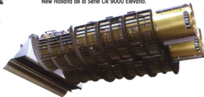
Rotores y cóncavos de la cosechadora New Holland de la Serie CR 9000 Elevatio.
