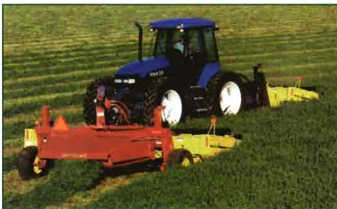
Enganches de tres puntos, tomas de fuerza y válvulas delanteras y traseras hacen del Bidirectional un auténtico tractor 'versátil', con un nivel de especificación inusual para un modelo norteamericano, entrando en la categoría de los tractores sistema y vendiéndose en Europa.
