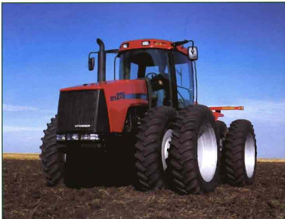
En los nuevos Case IH STX –con cabina de parabrisas y cristales curvados y un capo descendente y de sección transversal variable– la visibilidad es un aspecto que nunca antes había tenido tanto peso en el diseño de tractores articulados.
