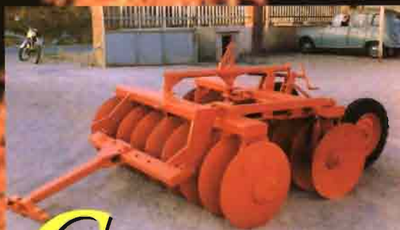
G RADA DE DESMONTE
