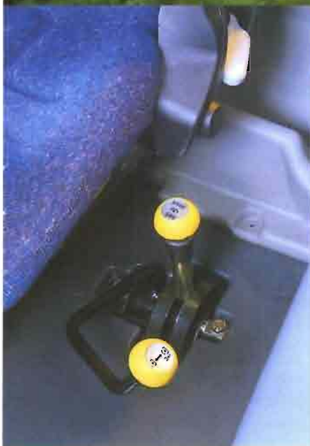
Esta serie ofrece la posibilidad de montar toma de fuerza delantera.
