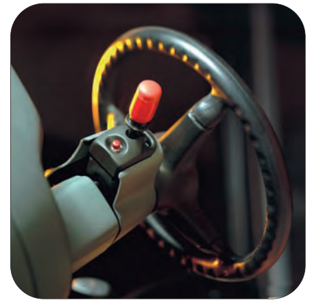
Inversor y freno de estacionamiento
