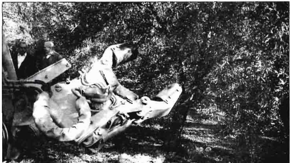
Pinza del vibrador que amordaza el tronco para derribar las aceitunas de un olivo de un solo pié y estructura rígida, idóneo para el derribo de aceitunas mediante vibración.
