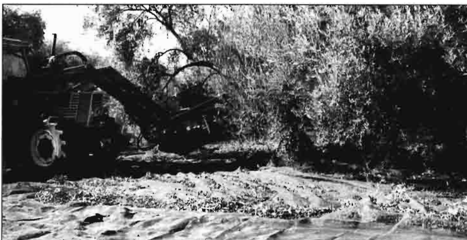
Recolección mecanizada mediante potentes vibradores de troncos, para el derribo de las aceitunas, cuya eficacia económica es cada vez mayor, sobre todo en olivos con altas producciones.
