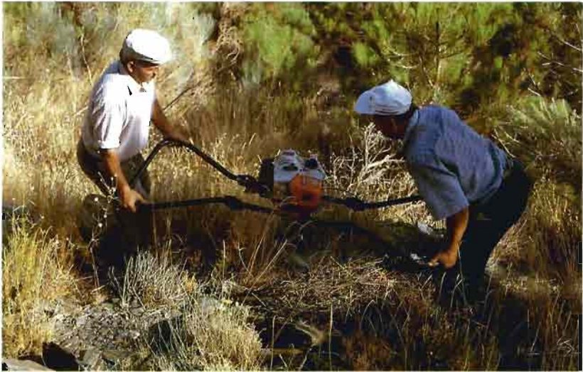
Fig 8. – Ahoyado con motoahoyadora manejada a mano.
