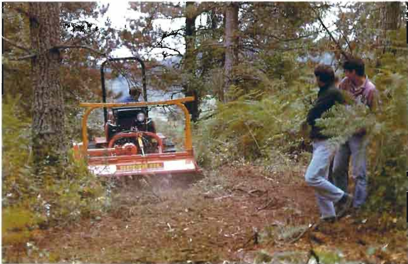
Fig 6. – Desbroce lineal con motodesbrozadora.
