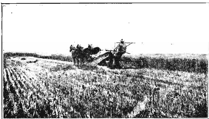
Siega mecánica de cereales: Segadora-atadora recolectando un extenso campo de trigo.
