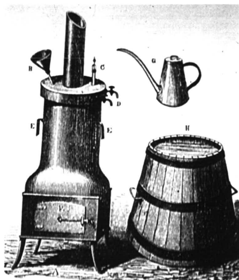
Fig. 69: Aparatos para destruir la piral de la vid: caldera, jarro de agua y tonel para la sulfurización. (JANINI, R.: Op. cit.).
