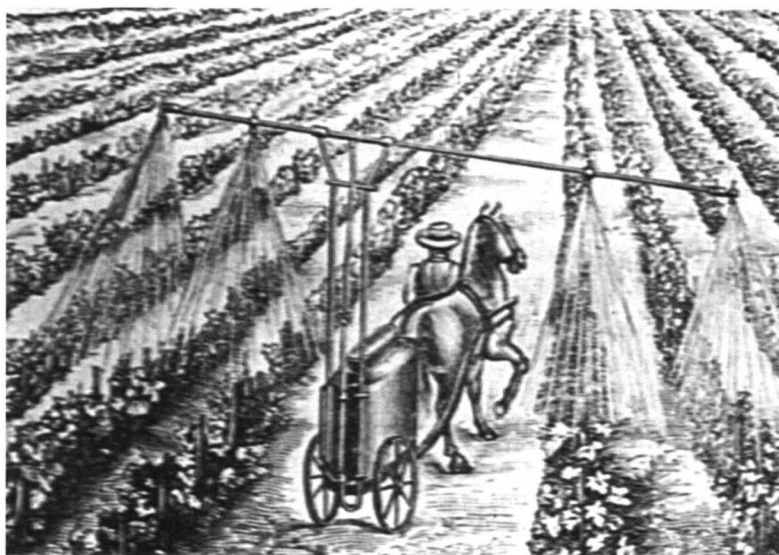
Fig. 63: Aparato Vermorell de tracción animal para aplicar el caldo bordelés. (FOEX, G.: Cours complet de viticulture. 4 de. Montpellier, 1895 ).
