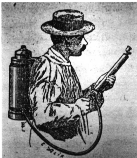
Fig. 59: Obrero con el aparato Vermorrell. (AZCARATE, C.: Insectos y criptógamas que invaden los cultivos en España, Madrid, 1983 ).
