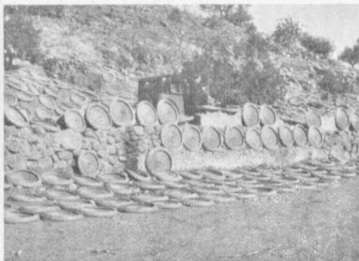
Capachos al sol después de limpiarse
