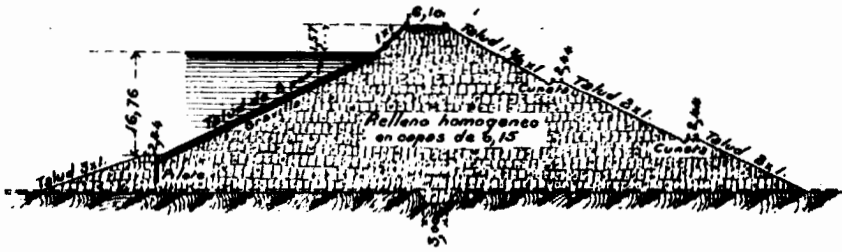
Sección transversal de la presa de Belle Fourche.
