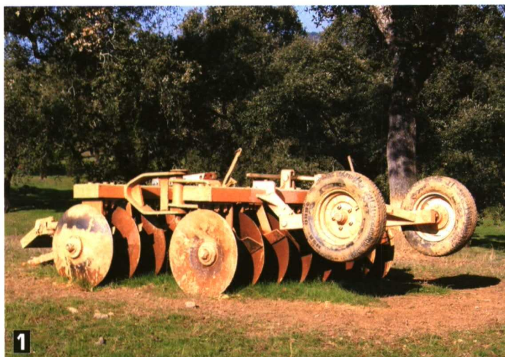
Foto 1. Grada de discos forestal para la eliminación de la vegetación preexistente.
