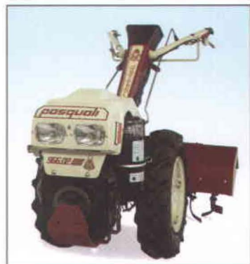
FIGURA 6.- MOTOCULTOR UTILIZADO COMO CUERPO DELANTERO PARA EL DISEÑO DE MICROTRACTORES
