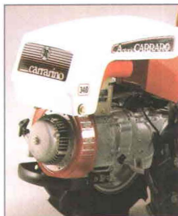
FIGURA 8.- SISTEMA DE ARRANQUE MEDIANTE CUERDA CON ENROLLADOR
