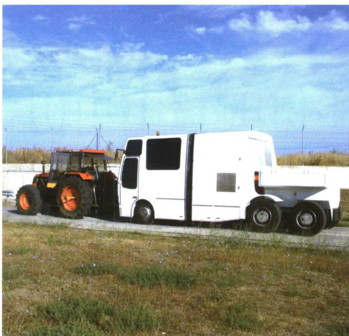
Carro dinamométrico para el ensayo de la potencia de tracción (EMA-España).
