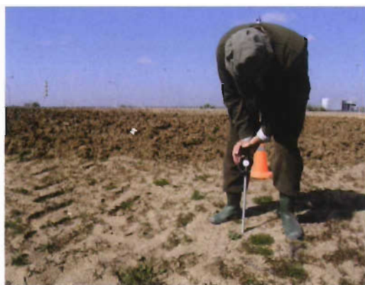
Medida de la resistencia de suelo.
