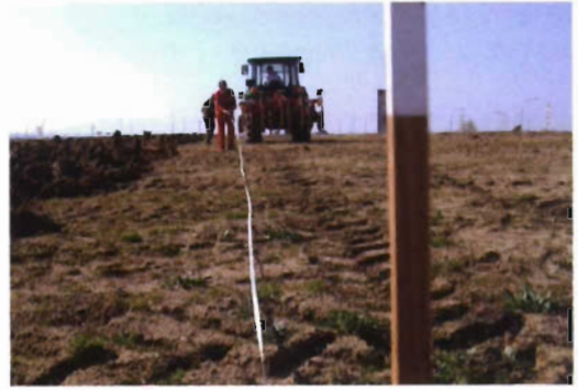
Medida del deslizamiento mediante jalones (5 vueltas de la rueda motriz).
