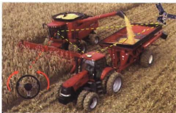
Guiado autónomo Case-IH AFS-V2V.
