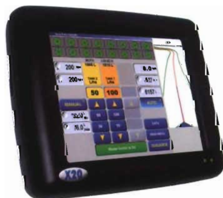
Monitor que responde a las especificaciones de la norma ISO 11783 (ISO-BUS).
