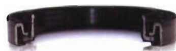
El sellado del embrague no slip ha sido diseñado con 4 labios para garantizar la protección contra el polvo y a prueba de agua.
