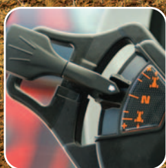
Power Control a la izquierda con tres funciones y neutro
