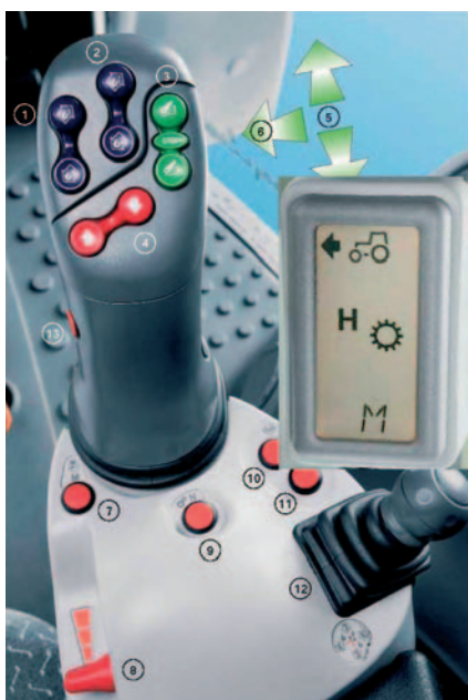
PowerComm S en el que se incorporan los mandos principales del tractor e indicador con la relación del cambio seleccionada
