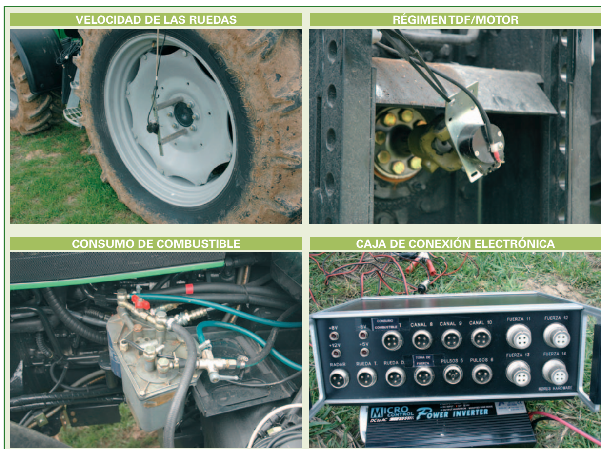
FIGURA 5.- DETALLES DE MONTAJE DE LA INSTRUMENTACIÓN
