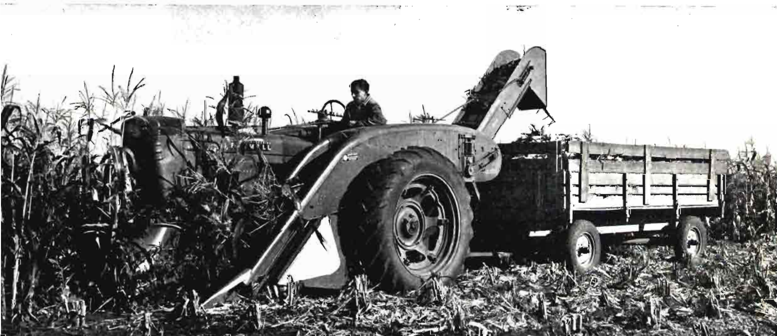
Esta cosechadora de mazorcas, muy parecida a la combinación de segadora y picadora de maíz, muestra la tendencia de utilizar el tractor como unidad motriz, montando sobre su armazón las máquinas operadoras, por complicadas que sean.
