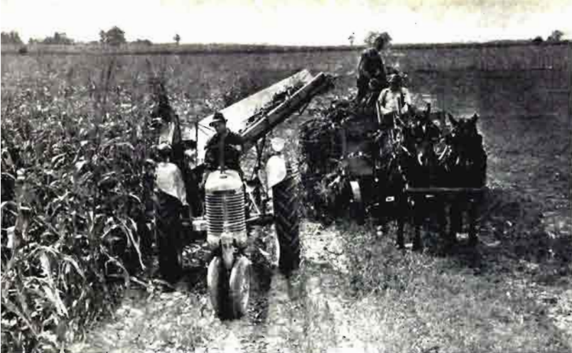
La segadora de maíz para silo y la ensiladora, que todavía encontramos separadas en estas fotografías, se han convertido también en máquina combinada, que, mientras marcha y tira del carro, pica el forraje. Basta luego voltear el carro en la tolva de un ventilador para llenar el silo sin otro personal que un obrero tractorista.
