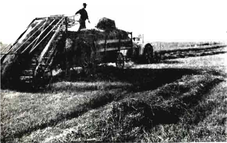
El heno era preciso acarrearlo hasta la empacadora fija. Hoy las máquinas automáticas lo recogen y atan en el mismo campo con un solo obrero. También son utilísimas para recoger la paja de las cosechadoras, como está haciendo la que vemos empacada con una cosechadora automóvil.
