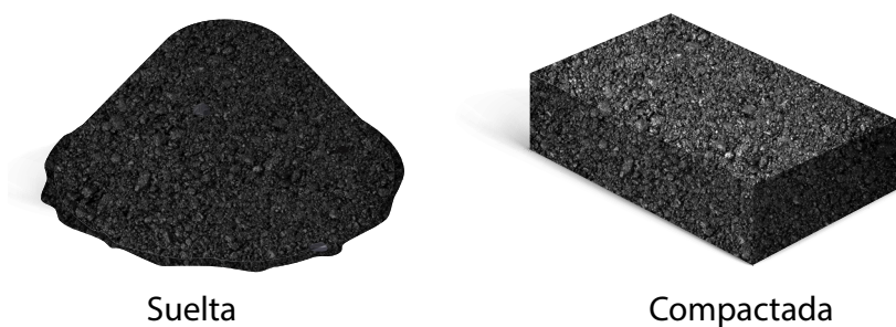
Figura 22. Mezcla asfáltica suelta y compactada.
