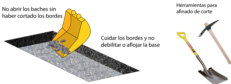
Figura 8. Remoción del material del bache
