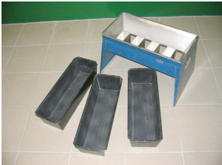
Figura 1. Reducción de muestras con cuarteador
