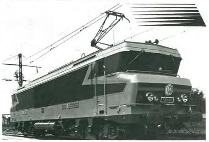
Locomotive électrique de 6 000 ch à courant industriel type BB 15 000.
