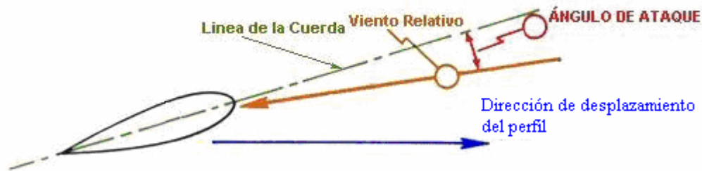
Figura 1.1.2 Definición de ángulo de ataque [3].
