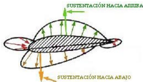
Figura 1.3.1 Perfil asimétrico con sustentación nula [3]
